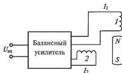
Рис. 19.8. Схема моментного двигателя с двумя обмотками (1, 2)
