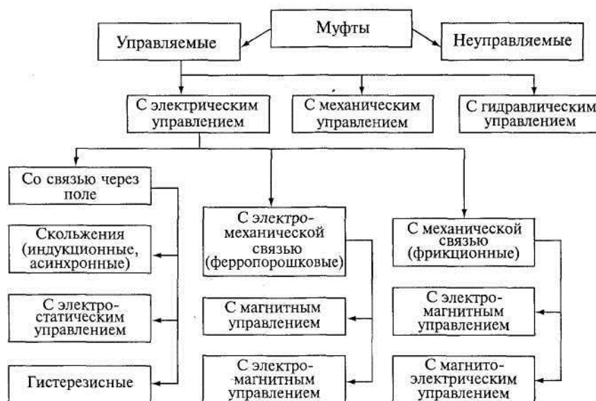
Рис. 16.1. Схема классификации муфт
