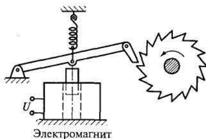
Рис. 19.1. Шаговый двигатель с электромагнитом и храповиком
