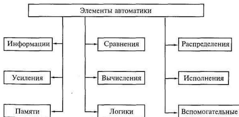
Рис. 1.7. Классификация элементов автоматики по функциональным признакам
