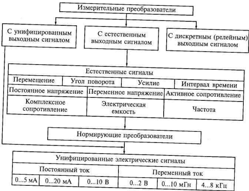
Рис. 4.2. Виды сигналов измерительных преобразователей
