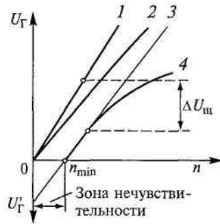
Рис. 6.9. Выходные характеристики 1...4 тахогенератора постоянного тока
